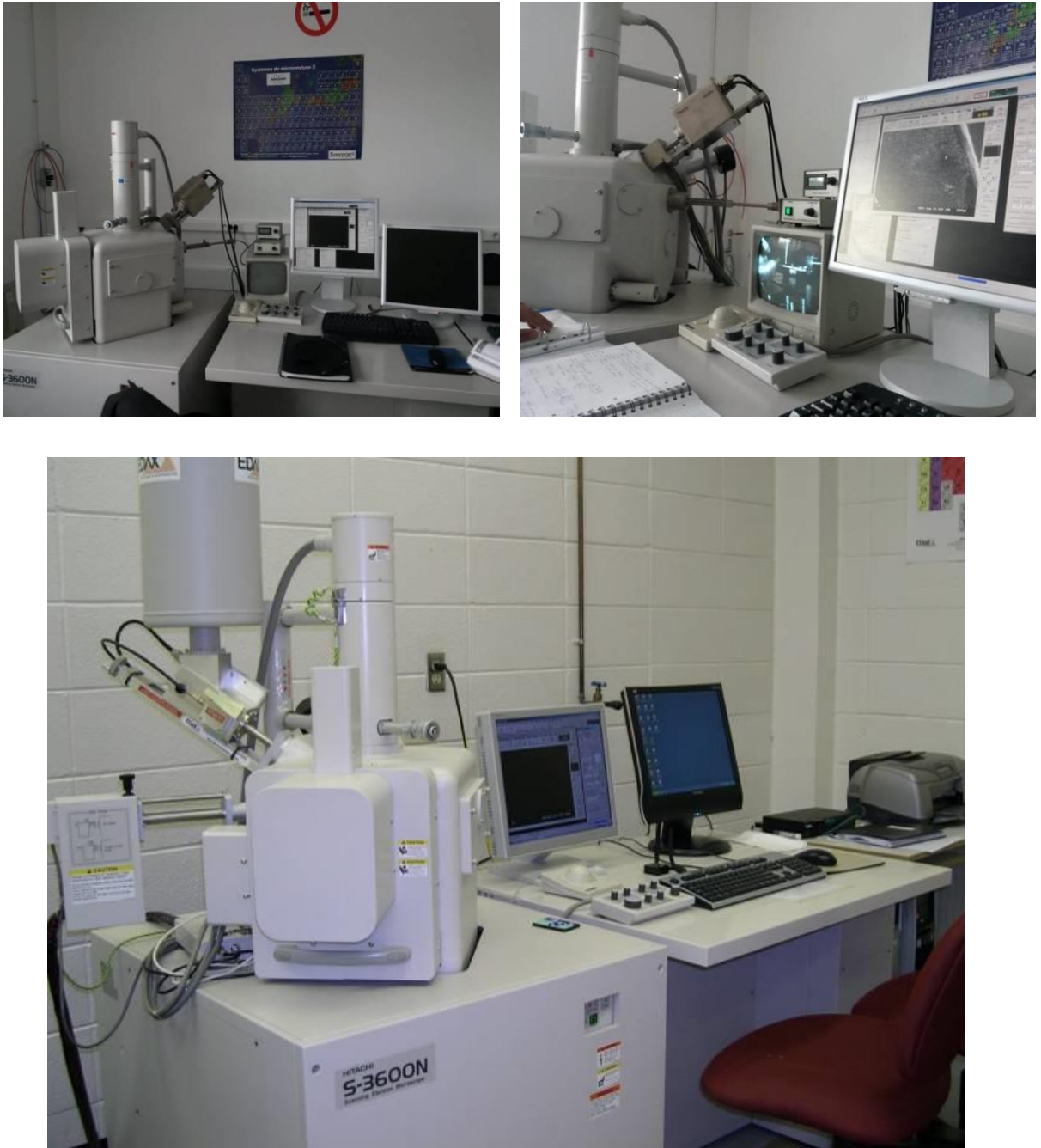
Рисунок 2.1 - Сканирующий электронный микроскоп HITACHI 3600 N (Япония), в лаборатории ЛМЛ, Франция.
