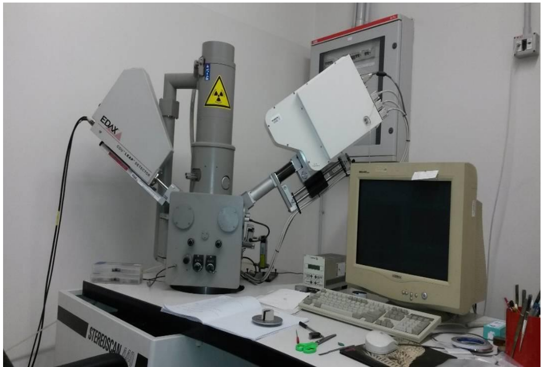
Рисунок 2.2 - Сканирующий электронный микроскоп SEM STEREOSCAN 440 (Англия), лаборатория индустриальной инженерии Падуанского университета, Италия.
