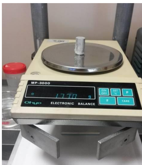
Рисунок 2.16 – Электронные весы для определения плотности по методу плавучести (Архимеда).
