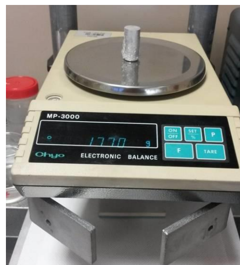
Рисунок 2.16 – Электронные весы для определения плотности по методу плавучести (Архимеда).
