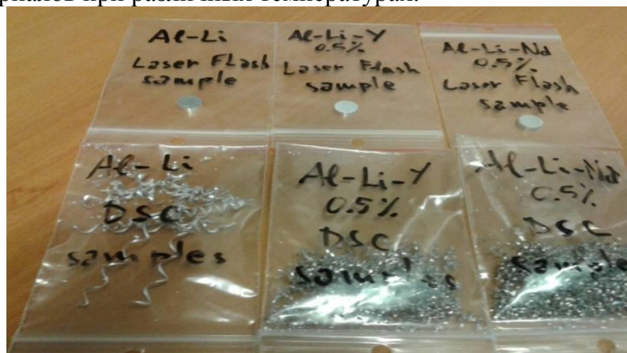
Рисунок 2.14 - Образцы для определения теплофизических свойств алюминиевого сплава Al+6%Li с РЗМ.
